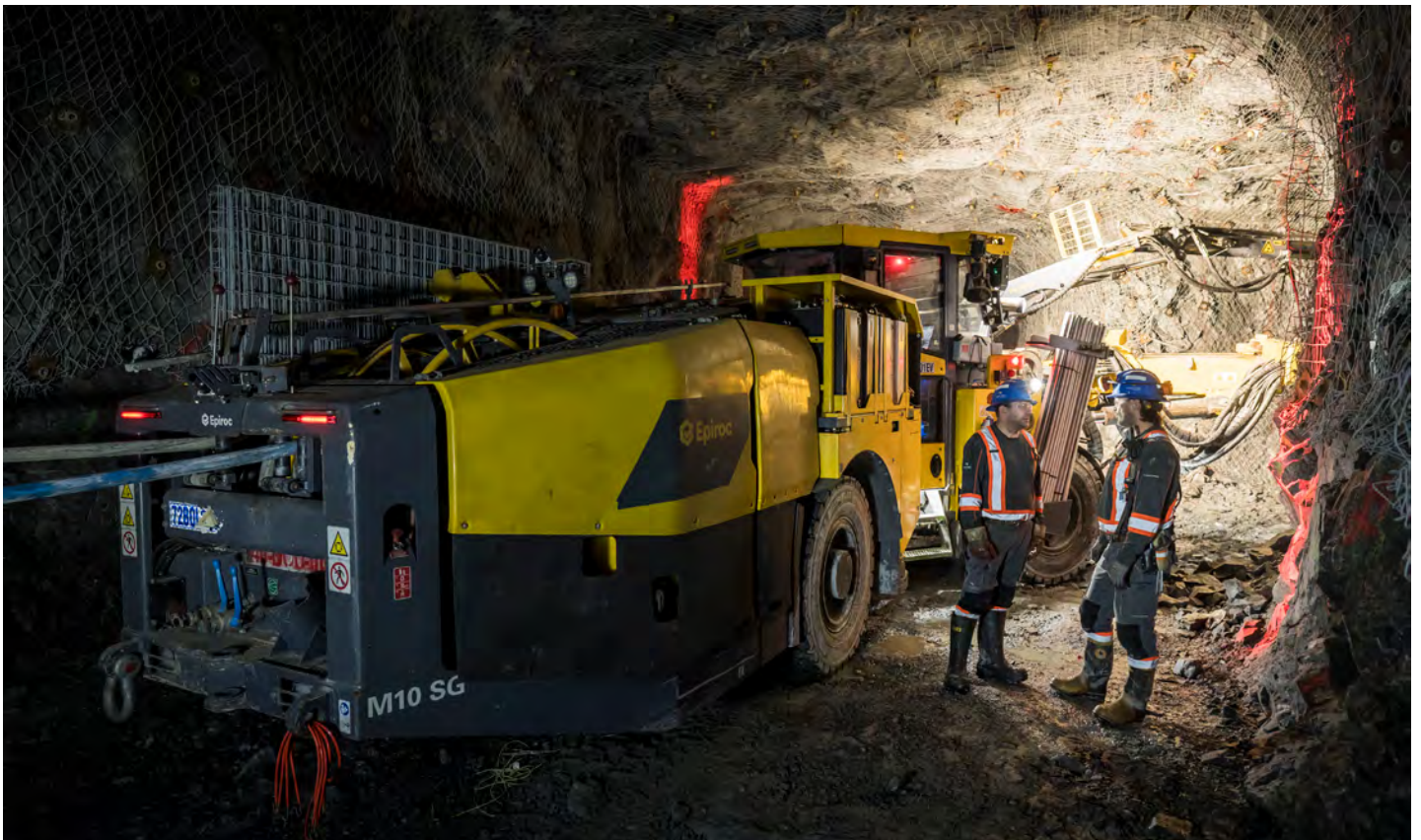
Boulonneuse électrique à batterie à la mine Odyssey (Québec, Canada).
